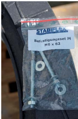
Foto 5 - 9 Befestigungsset M mit 2 expansionsfreien Lastankern. Mit Spezialbohrer ohne Schlaghammer Löcher für Lastanker bohren (s.h. Datenblätter). Bolzenanker auf entsprechende Setztiefe mit Hammer einschlagen, Muttern und Rahmen wieder entfernen. Zwecks Abdichtung Falz mit Brunnenschaum (z.B. Sika-Boom D) Ausschäumen. Rahmen auf die 2 Bolzenanker aufsetzen und mit U-Scheiben und Muttern anschrauben.
